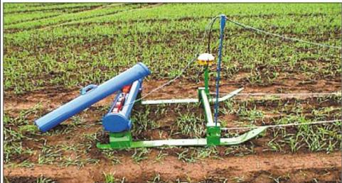
Abbildung 2: Messschlitten für das EM 38.
